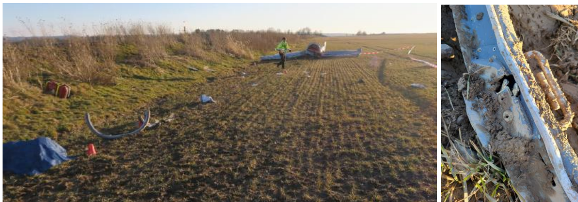
Obr. č. 7 – Pohled na prostor před vrakem UL letounu, detail otevřeného jednopohového zámku (pozice 10)
