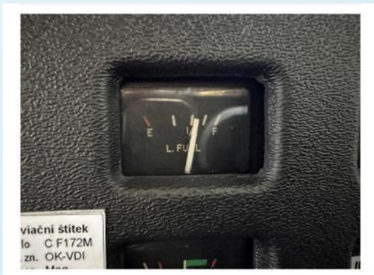
Vadná indikace – levý palivoměr
