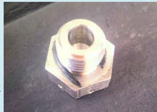
Poškozený těsnící kroužek
