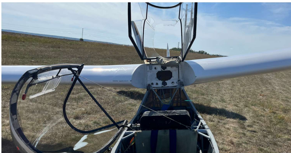
Obr. 1 – Poškozený zadní kryt kabiny kluzáku
