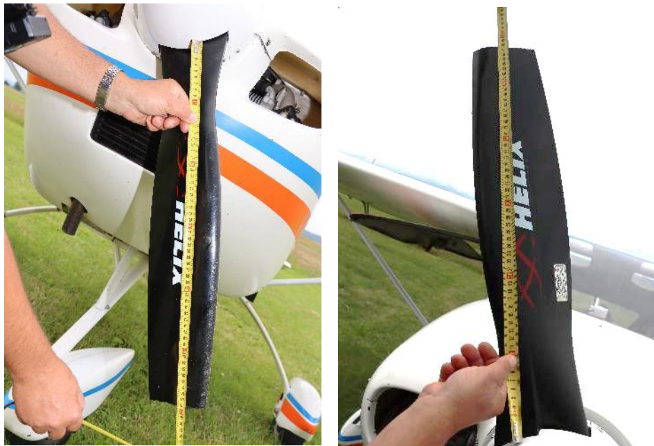
Obr. 7 – Stav vrtule UL letounu pozn. značky OK-VUO 01
