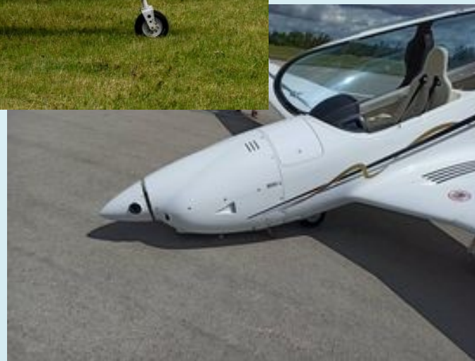
Neúplné vysunutí předového podvozku
