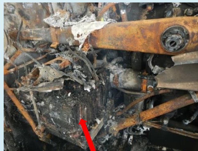
Poškozená palubní baterie
