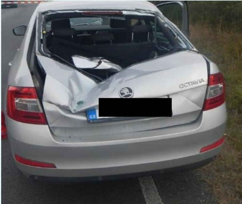
Poškození vozidla nárazem levé poloviny křídla kluzáku
