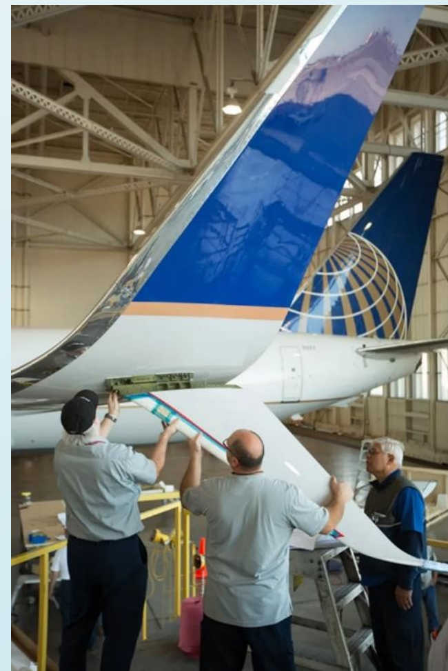
Ilustrační foto - montáž „ventral strake“ na B-737-800 (foto z internetu)
