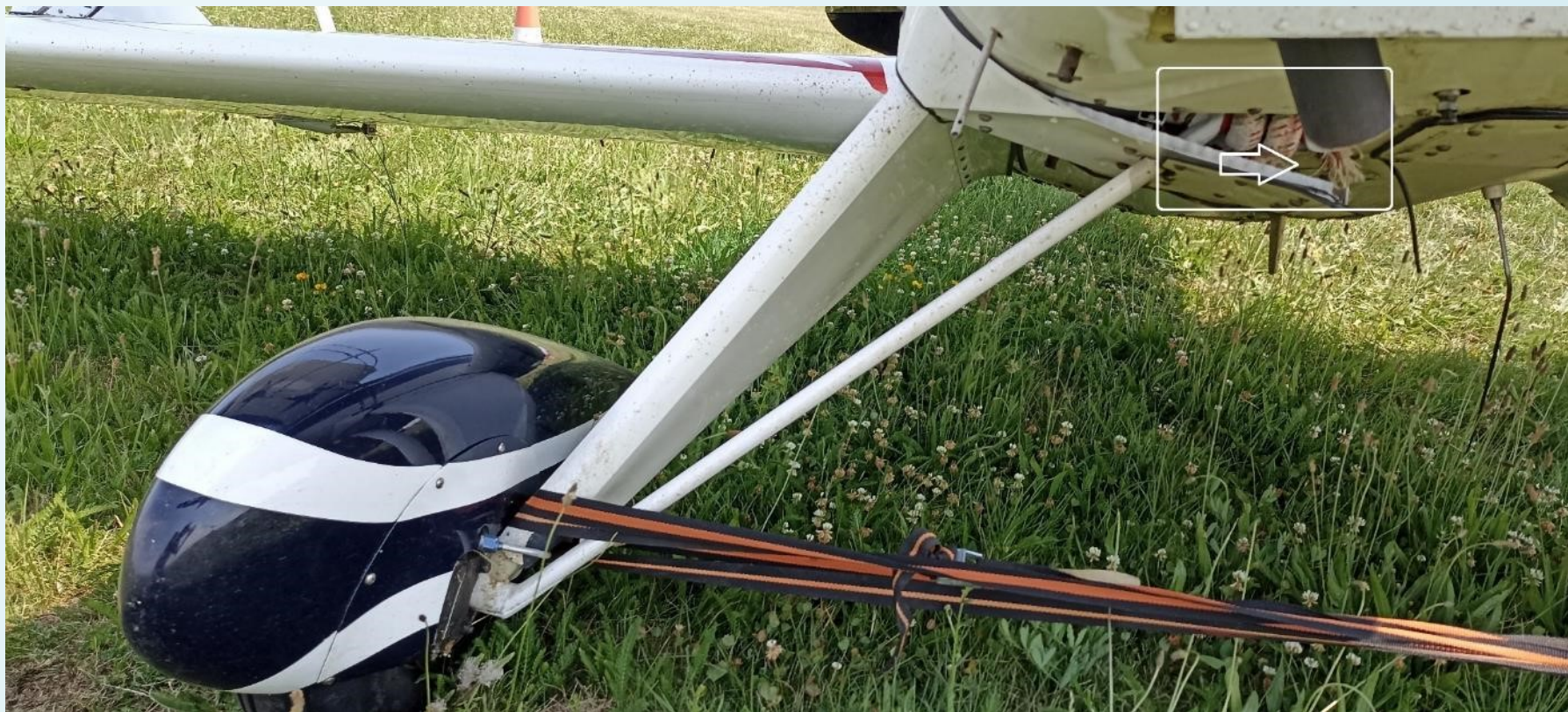
Prasklé gumové odpružení podvozku letounu PITTS S-2B SPECIAL
