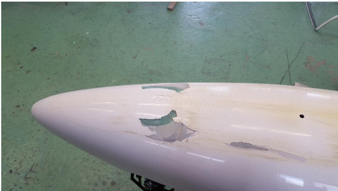
Obr. 8 – Poškození přední spodní části trupu
