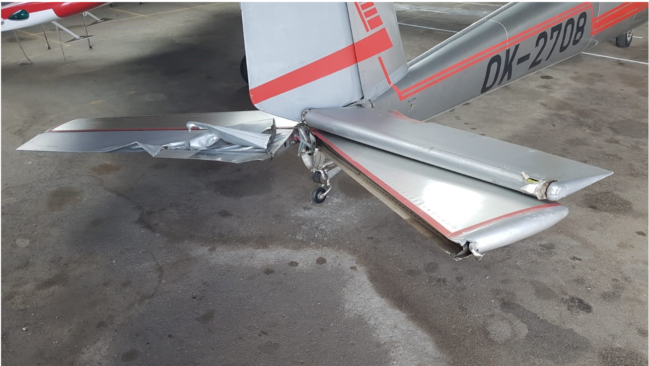
Obr. 3 Poškození ocasních ploch
