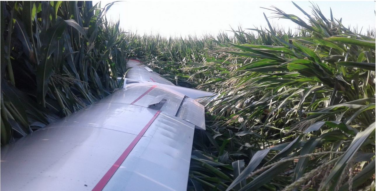
Obr. 1 Detail křídla s vysunutými vzdušnými brzdami a vztlačovými klapkami
