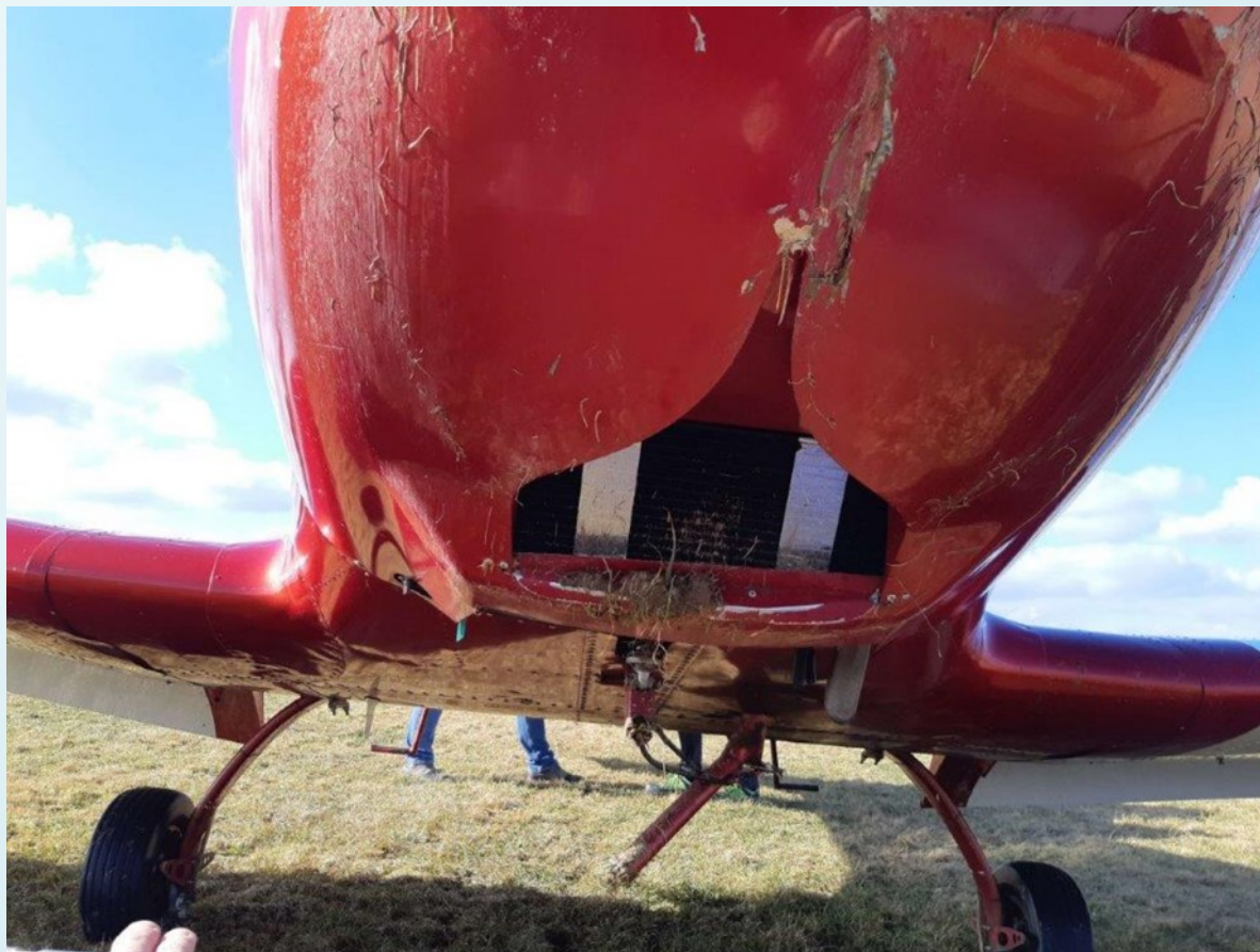
Poškození UL letounu v důsledku tvrdého dosednutí
