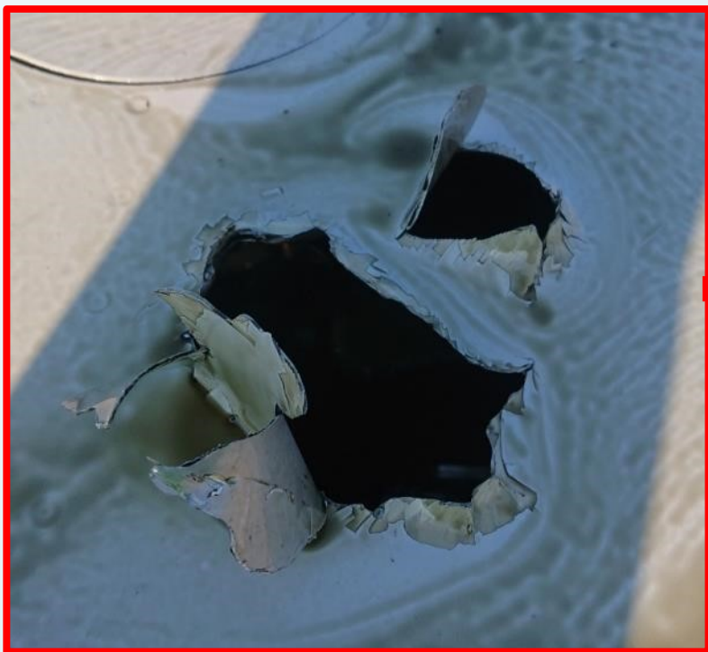
Poškozený horní potah levé motorové gondoly
