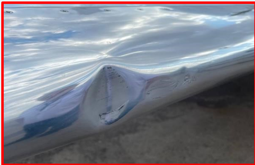
Poškození náběžné hrany
