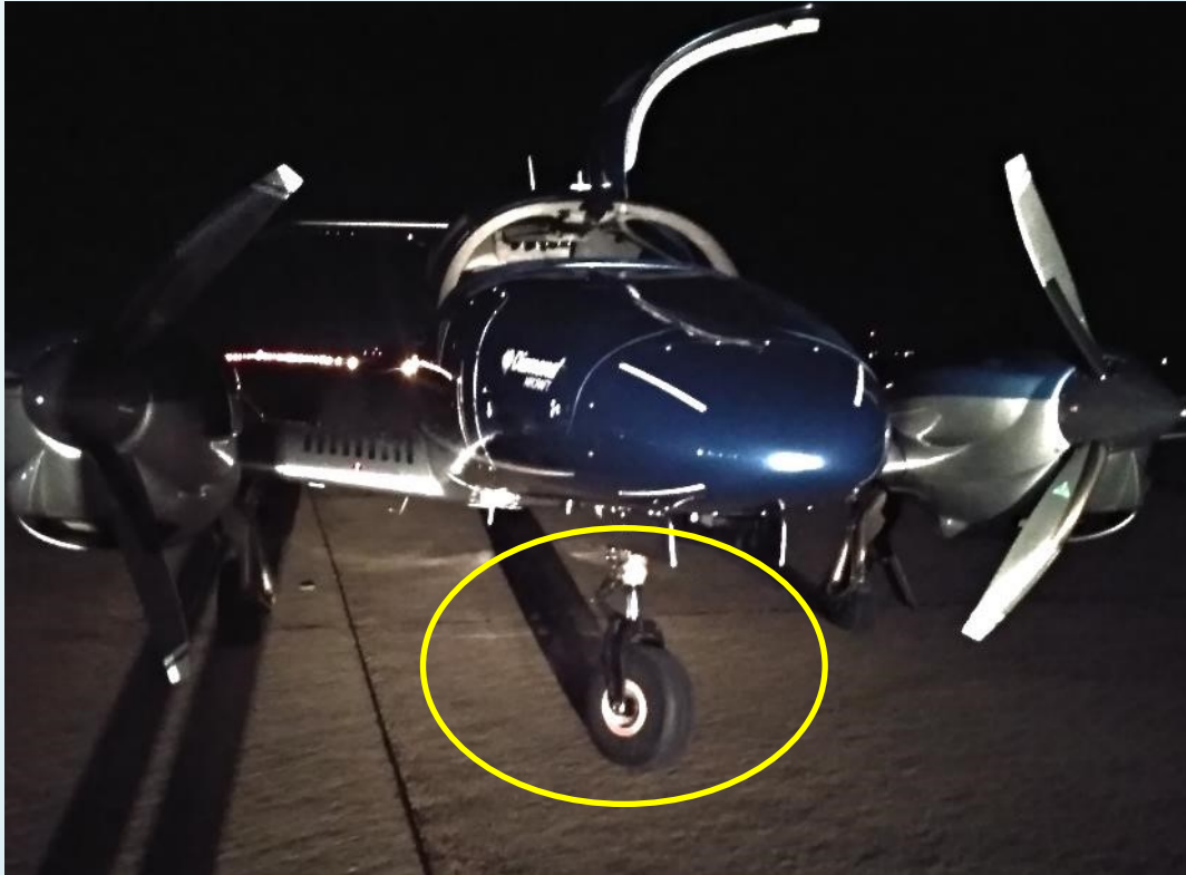
Zablokovaná přední podvozková noha ve vytočené poloze
