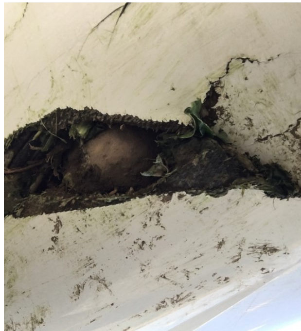
Obr. 4: Proražení trupu bulvou řepy
