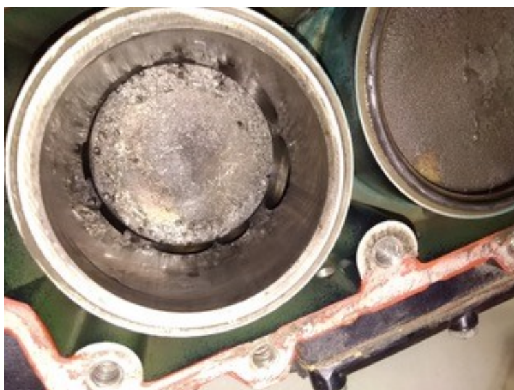
Obr. 5: Zadřený píst motoru
